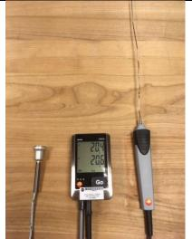
Messinstrument, von links nach rechts : Tempertaturschreiber Testo 176T4, Raumtemperaturfühler Testo 06024892 Typ K, Tauchfühler 06020593 Typ K
